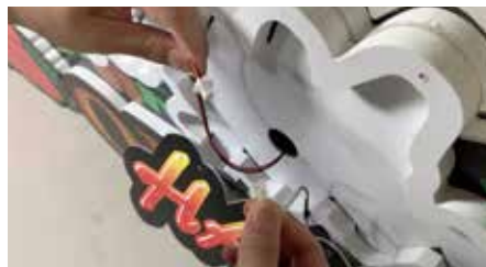
新しいパネルの端子を付け替えます。 ビス留めを再度行い完了です。
